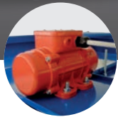
Motor shaker Oklep filtrů
